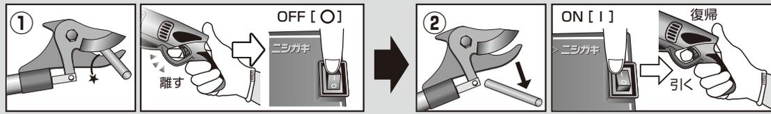
異物を挟むなどでハサミ部が停止した際はトリガーから指を離し、バッテリーのスイッチをOFFにします。
