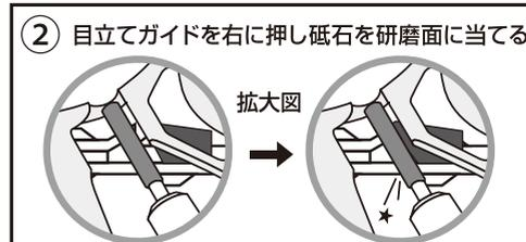
ポイント：回転を落とさないように2~3回軽く押し当て目立て完了！
