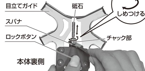
本体の回転ロックボタンを親指で押しチャック部を手で回転させ回転軸を固定し、付属のスパナ(9.5mm)でチャック部(袋ナット)を緩めて取り替えてください。(右回し：締まる/左回し：緩む)
