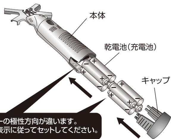
**注意** 上段・下段で電池の+-の極性方向が違います。本体内側両面の極性表示に従ってセットしてください。
