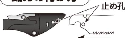
鋸刃を背金に挿入(矢印)して背金と刃の止め孔を合わせて止めネジを取り付けてください。緩まないようにコイン、ドライバー等で増し締めしてください。
