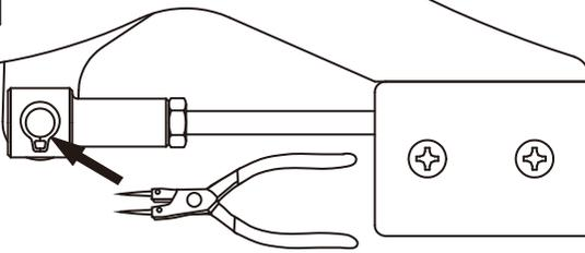
① スナップリングプライヤーで
